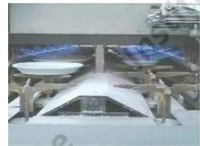
Pulvérisation sur carrousel d'émaillage automatique pour pièces vitrifiées avec chauffage préalable et séchage par brûleur.
