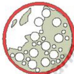
Vitesse normale, les billes montent jusqu'à 75% de la hauteur du broyeur et sous l'effet de la gravité retombent en roulant les unes sur les autres, broyant des particules d'émail à chaque contact entre billes.
