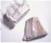
Kaolin apportant de la Kaolinite 2SiO<sub>2</sub> Al<sub>2</sub>O<sub>3</sub> 2H<sub>2</sub>O utilisé, comme source d'alumine et de silice, il évite également la sédimentation des bains (attention max 12% en cru)
