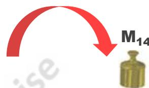
Pour rétablir l'équilibre, il faut enlever des poids sur le plateau de droite, la masse enlevée  $M_{12} - M_{13} = M_{14}$  correspondra à la force de poussée d'Archimède soit l'équivalent de la masse du volume de l'eau déplacée (ou remplacée) par le liquide, en fait cela revient à mesurer le volume de l'échantillon.
