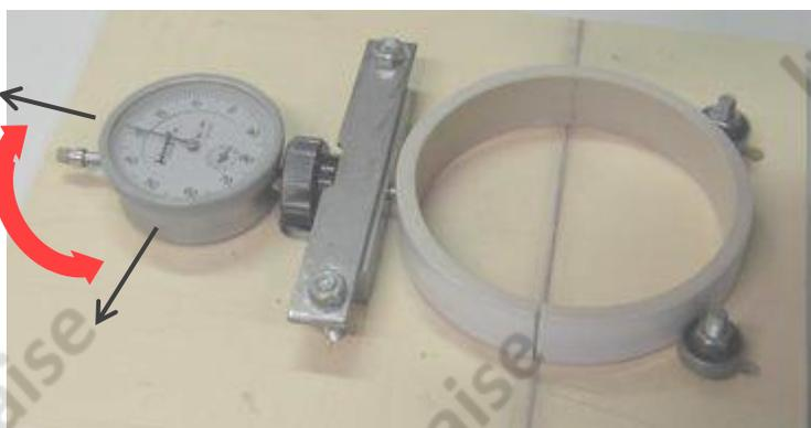
L'anneau est repositionné sur les mêmes repères et la différence entre le diamètre avant et après la coupe diamant est mesurée, si le diamètre augmente, l'émail est d'un coefficient de dilatation supérieur à celui de la pâte et il est en tension, il y a un risque de tressillage. A contrario, si le diamètre diminue cela signifie que l'émail est en compression, c'est-à-dire que son coefficient de dilatation est inférieur à celui de la pâte et il présente des risques d'écaillage.
