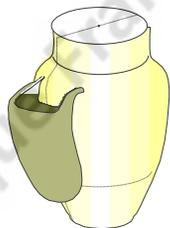
Monter un enterrage en pâte contre le modèle à des dimensions légèrement supérieures à celles du bec.
