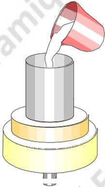
Confectionner une cerce en zinc aux dimensions proches de celles du modèle. Décoffrer l'entourage aussitôt que possible (le plâtre doit être très mou pour permettre le travail au gabarit).
