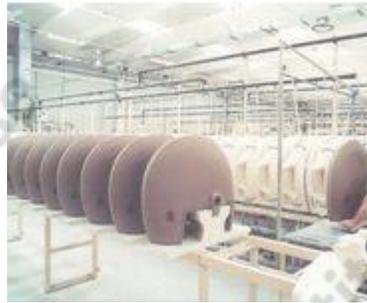
Sous l'effet de la capillarité du moule, l'eau sera pompée ; ce qui aura pour effet de constituer une épaisseur sur la surface du moule, **c'est le phénomène de la prise**. Après plusieurs minutes et jusqu'à plusieurs heures pour les grosses pièces, on aura constitué une épaisseur conséquente et propre à résister à la déformation après sa phase de démoulage.
