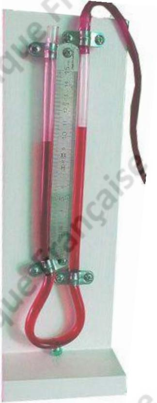
Contrôle des pressions dans l'enceinte du four, qui intéresse principalement les utilisateurs de fours tunnel où les différentes zones de cuisson ne doivent pas se déplacer. En effet, les variations de charges des wagonnets ou les variations de cadences peuvent emporter la zone de feu en aval de sa position normale et, de ce fait, perturber la courbe initiale de montée en température. Un des moyens simples de recaler celle-ci sera de jouer sur les registres d'évacuation des fumées.
