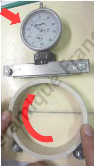
Positionnement de l'anneau et mise en rotation jusqu'à affichage du plus petit diamètre.
