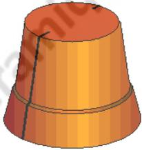
Pratiquer une « saignée » de deux à trois centimètres de profond et d'une largeur de 1 mm.
