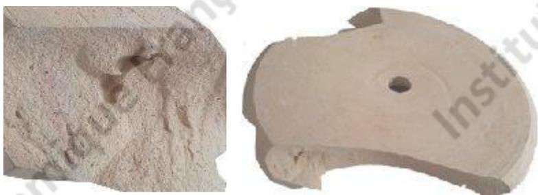
Éclatement dû à des bulles d'air emprisonnées pendant le calibrage. Une des solutions consiste à percer la pièce avec une mèche de petit diamètre pour permettre l'évacuation de l'air pendant son échauffement.
