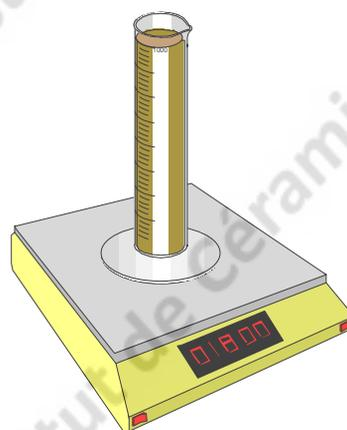
Poser l'éprouvette pleine de barbotine sur la balance, celle-ci indiquera une masse en grammes (par exemple 1800 g) qui donne la densité de la barbotine en g/litre.
