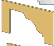
Confection du gabarit dans une tôle de zinc, à l'aide d'une scie sauteuse et finition à la lime.
