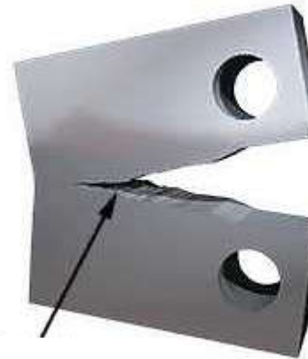
Fissure se propage
